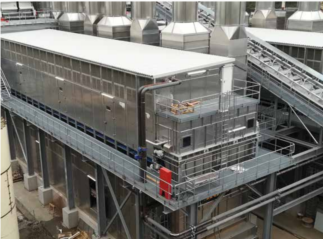
Projekt: Kronospan Luxem- bourg S.A., Luxemburg Typ: 2x BTU 2/6200-57-16-6 Jahr: 2018 Produkt: OSB-Strands Trocknerausgangsleistung: 2x 30,6 t/h von 100% - 2% BD
