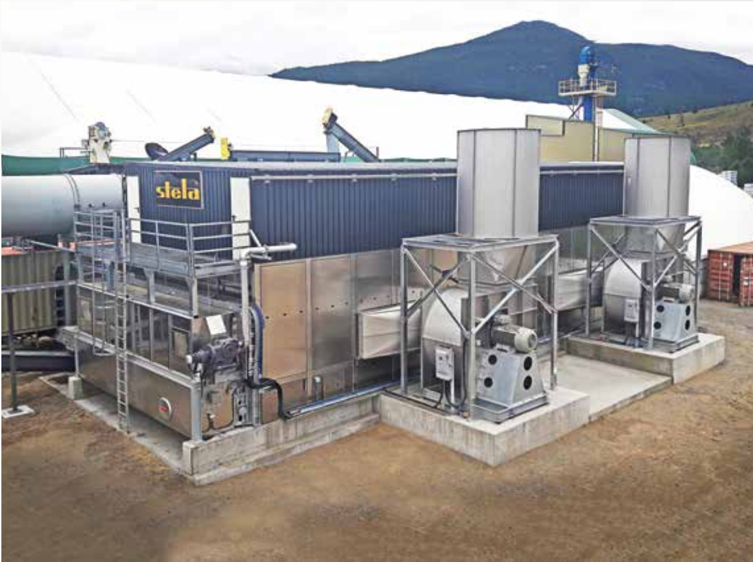
Projekt: Diacarbon Kanada Typ: BT 1/6200-19,5 Jahr: 2017 Produkt: Sägespäne Mix Trocknerausgangsleistung: 5,56 t/h von 50% - 10% MC
