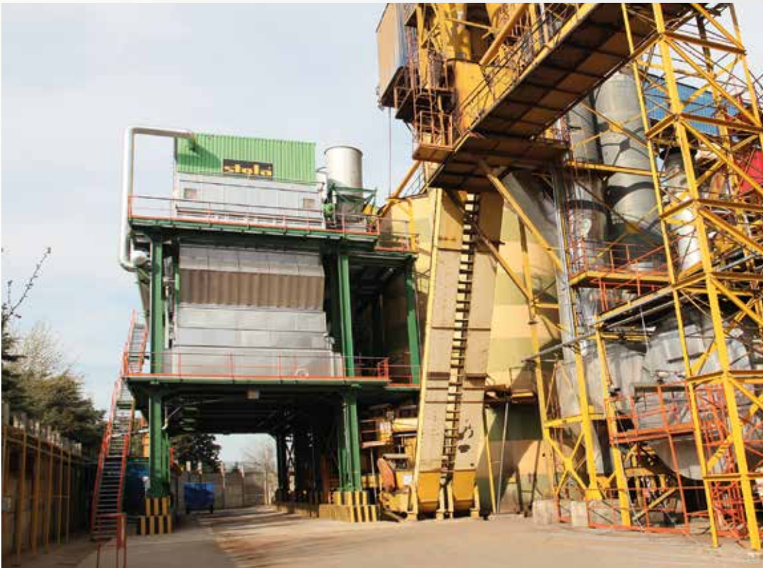
Projekt: Starwood AS Türkei Typ: BT 2/6200-22,5 Jahr: 2018 Produkt: Holzspäne Trocknerausgangsleistung: 12,8 t/h von 100% - 1,5% BD
