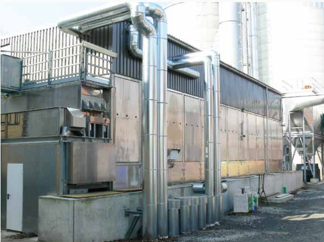
Projekt: EVO Energie- versorgung, Deutschland Typ: BT 1/6200-19,5 Jahr: 2010 Produkt: Sägespäne Trocknerausgangsleistung: 6,0 t/h von 50% - 9% MC
