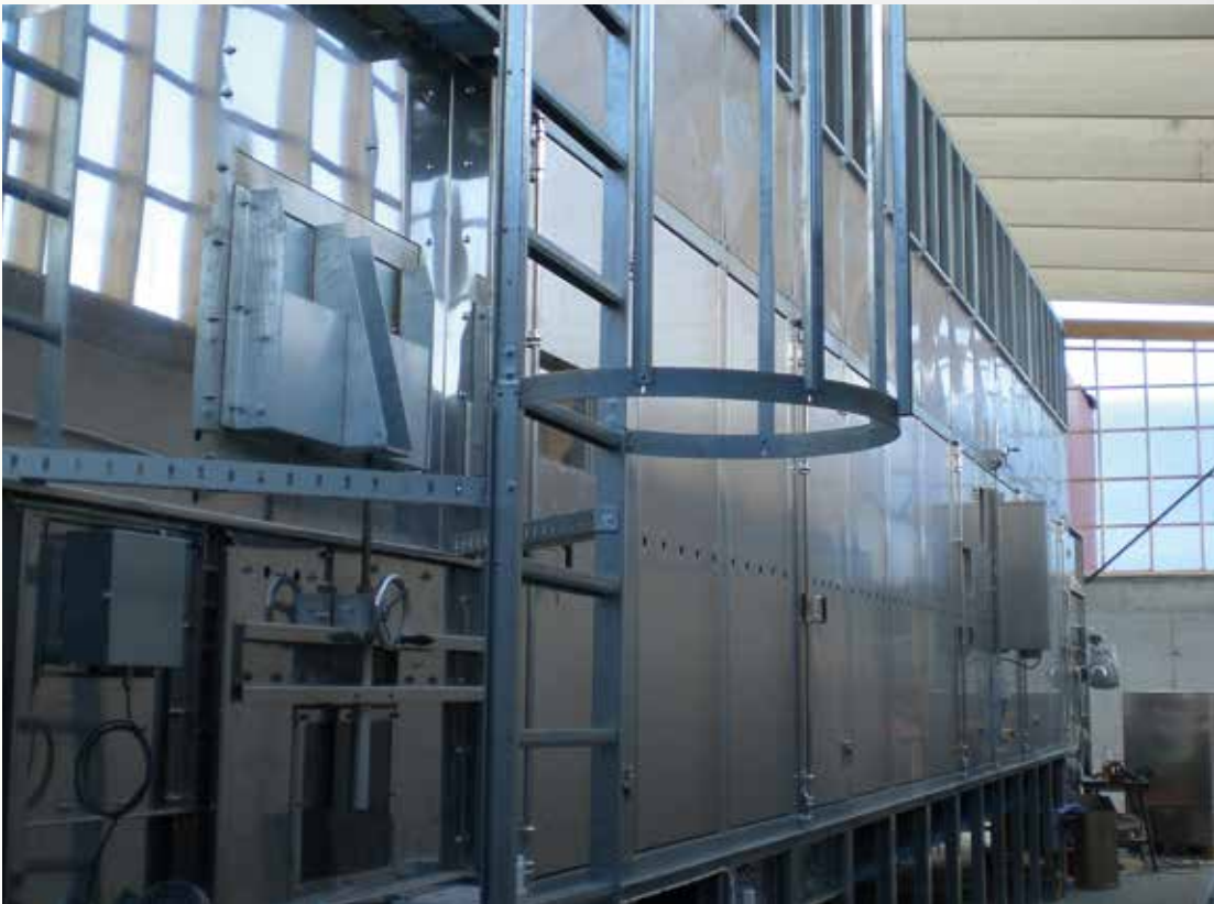
Projekt: Krekula & Lauri Schweden Typ: BT 1/2700-14 Jahr: 2008 Produkt: Sägespäne Trocknerausgangsleistung: 2,0 t/h von 50% - 10% MC
