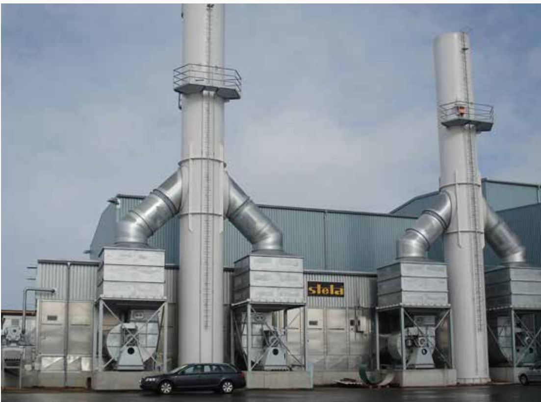
Projekt: Trocknung Ruderatshofen, Deutschland Typ: BT 1/6200-33 Jahr: 2007/2008 Produkt: Hackschnitzel, Rinde, Gras, Stroh Wasserverdampfung: 8,0 - 10,0 t/h
