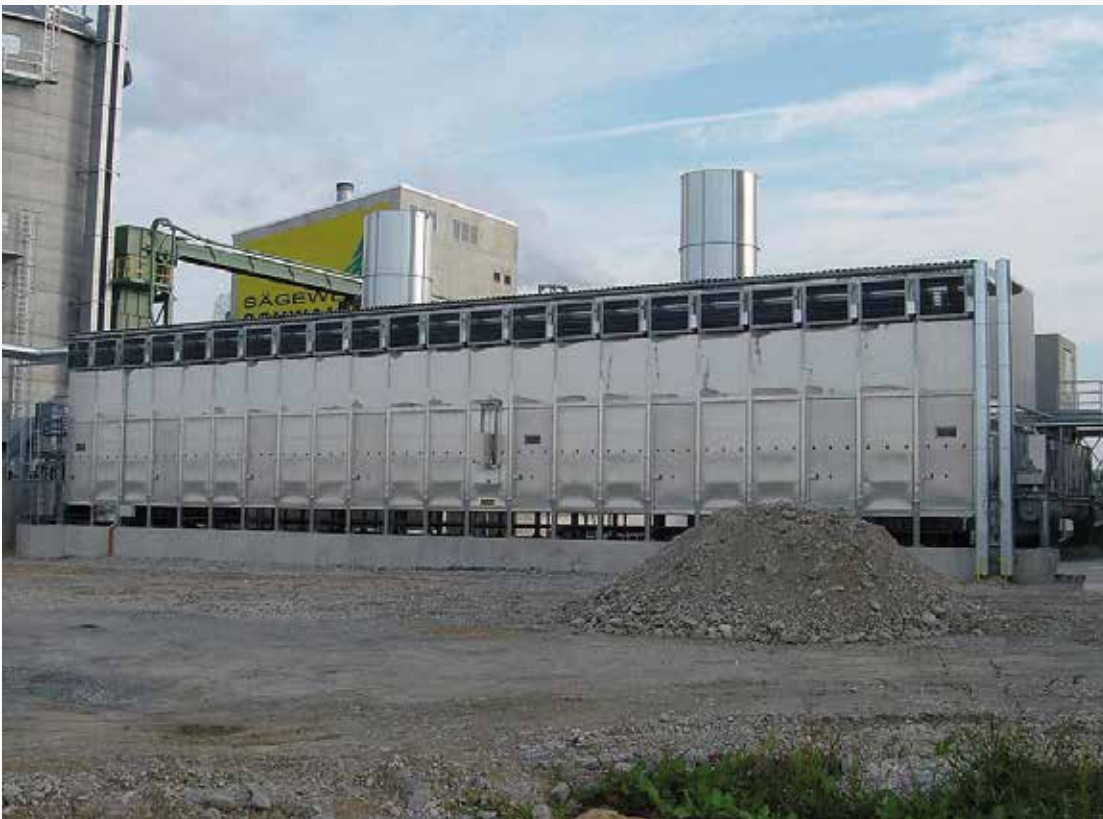
Projekt: Sägewerk Schwaiger, Deutschland Typ: BT 1/6200-33 Jahr: 2006 Produkt: Sägespäne Trocknerausgangsleistung: 10,5 t/h von 50% - 10% MC
