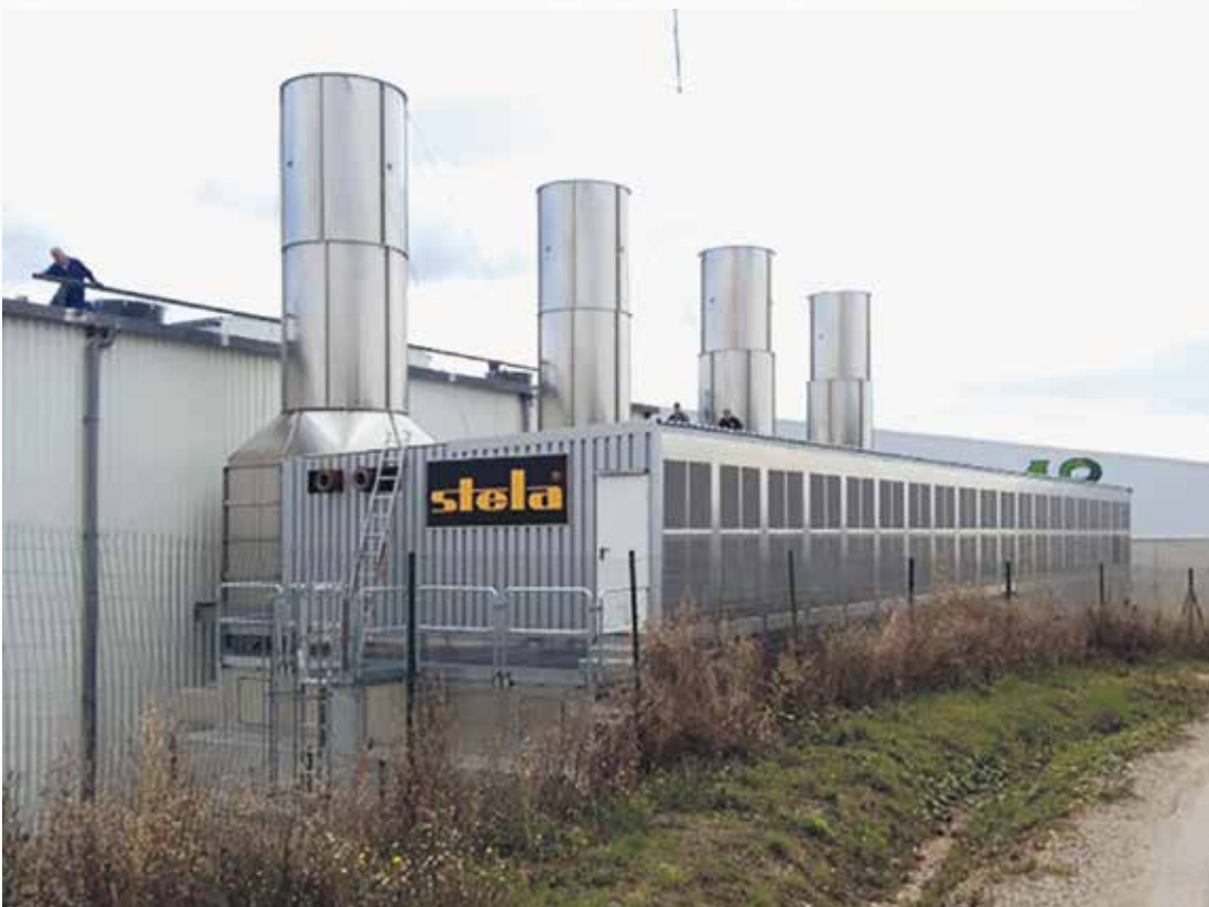
Projekt: SAS B.C. 48 Frankreich Typ: BT 1/6200-30 Jahr: 2016 Produkt: Sägespäne Trocknerausgangsleistung: 8,4 t/h von 50% - 8 % MC
